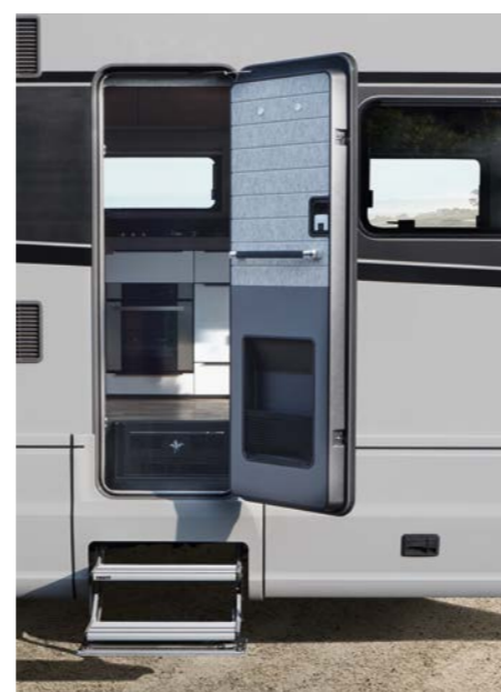
1 Porte intelligente avec degré d'ouverture commandé par capteurs
